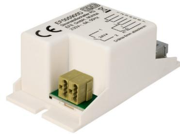
werden zum Schalten der Raumbelichtung oder des Betten-/Leselichts über Handgeräte der Rufanlage eingesetzt und an die LT1- und LT2-Ausgänge der Geräte mit Nebensteckkontakt (NS, NSM ...) angeschlossen. Das Gerät verfügt über eine eigene galvanisch getrennte Stromversorgung. Der Einbau erfolgt entweder in einer UP-Schalterdoppeldose oder in medizinischen Versorgungseinheiten.
